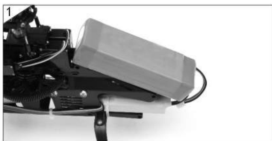
将电池放入电池槽
